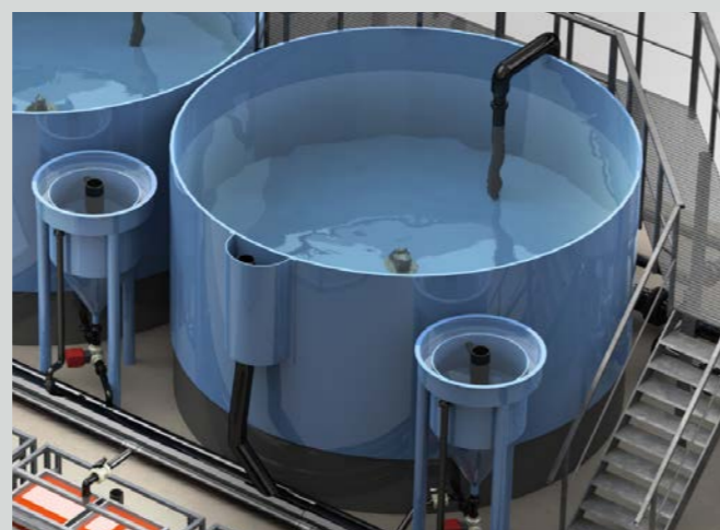
Partikkelseparator og kar med todelt avløp hvor 85 % av vannet passerer ut gjennom et sideavløp og føres ut i avløpsledning. Resterende vannmengde går ut gjennom senteravløp i bunn, og må passere partikkelseparator, før det føres videre til avløpsledning og rensing i mekanisk sil.
